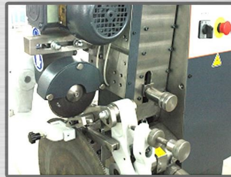
Скос правой/левой фасок зубьев пил HSS вручную
